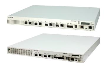
OmniAccess 4x50-Serie in der Lage, 32.768 mobile Geräte zu unterstützen und verbindungsorientierte Firewall-Richtlinien bei 100 Gbit/s anzuwenden – ausreichend Kapazität und Geschwindigkeit für BYOD und Geräte gemäß IEEE 802.11ac.
