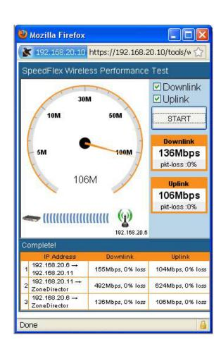
SpeedFlex" ist ein einzigartiges, in den zentralisierten Controllern der ZoneFlex"-Reihe integriertes, drahtloses Tool zur Leistungsüberprüfung, das den Wi-Fi- Durchsatz der zugeordneten WLAN-Clients misst.
