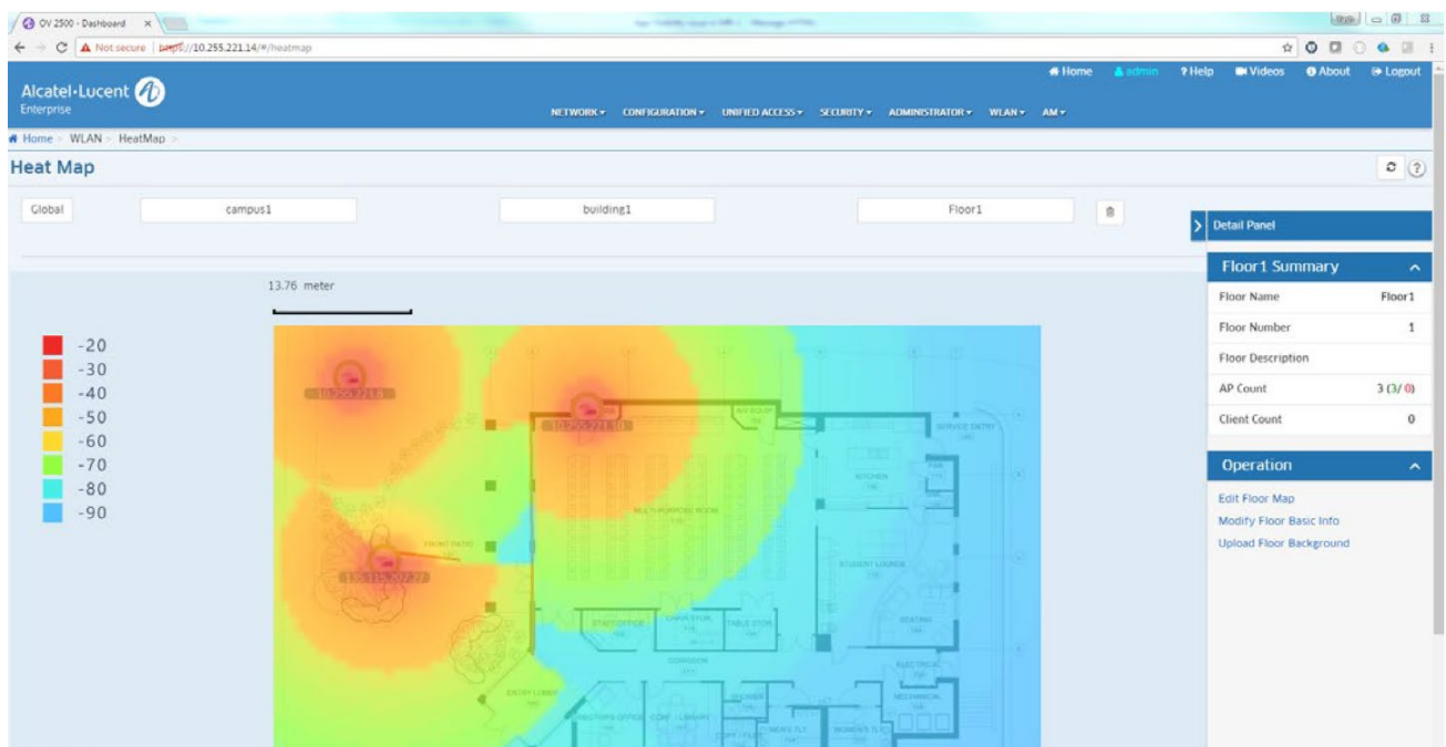
Abbildung 4. Heatmap zur Optimierung der Wi-Fi-Abdeckung und der Leistung
