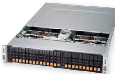
2HE, 4 Nodes BigTwin mit 24x NVMe SSDs oder 6x NVMe SSDs pro Node
